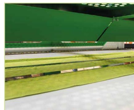
A(s) dobra(s) primária(s) é/são feita(s) por um fluxo de ar pulsado. Antes de ter sido realizada por completo a primeira dobra, mede-se o comprimento. É na base deste comprimento que se pode selecionar um dos muitos possíveis padrões de dobragem. Os modelos de dobragem são automaticamente postos na posição correta e os bicos de pulverização de ar pulsado dobram a peça firmemente à volta dos modelos. A longa dobra primária pode dobrar peças de até 2300 mm.
