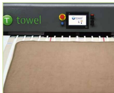
As peças são postas na correia transportadora de entrada. Esta correia transportadora começa a funcionar assim que deteta a peça ou após ativação manual com um botão na parte lateral da máquina.
