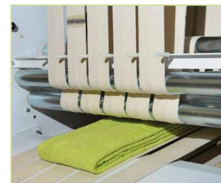
A **t.Towel** é equipada com duas seções de dobragem transversal. Cada dobra transversal é feita através da inversão das correias em combinação com um impulso de ar, o que resulta numa dobra muito precisa e firme. Ao longo da programação das posições de dobragem, podem ser realizados vários modelos de dobragem. Também é possível fazer um bypass (sem necessidade de dobragem transversal).
