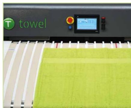
A **t.Towel** é fornecida com um dispositivo especial para dobrar peças que precisam de ser corrigidas antes de serem dobradas, tais como lençóis de baixo ajustáveis. Depois de pôr o lençol na mesa de alimentação e apertar o botão, a peça entra na máquina e pára automaticamente para corrigir a extremidade posterior da peça. Em seguida, o operador aperta o botão uma segunda vez para iniciar o processo de dobragem.
